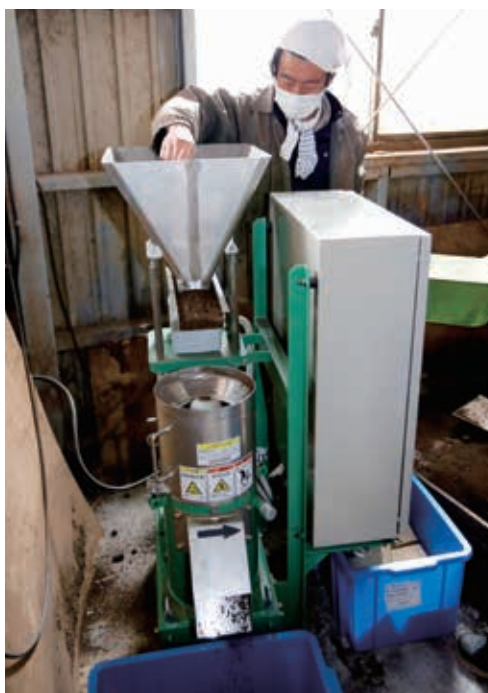
導入した造粒機(高津区子母口)
